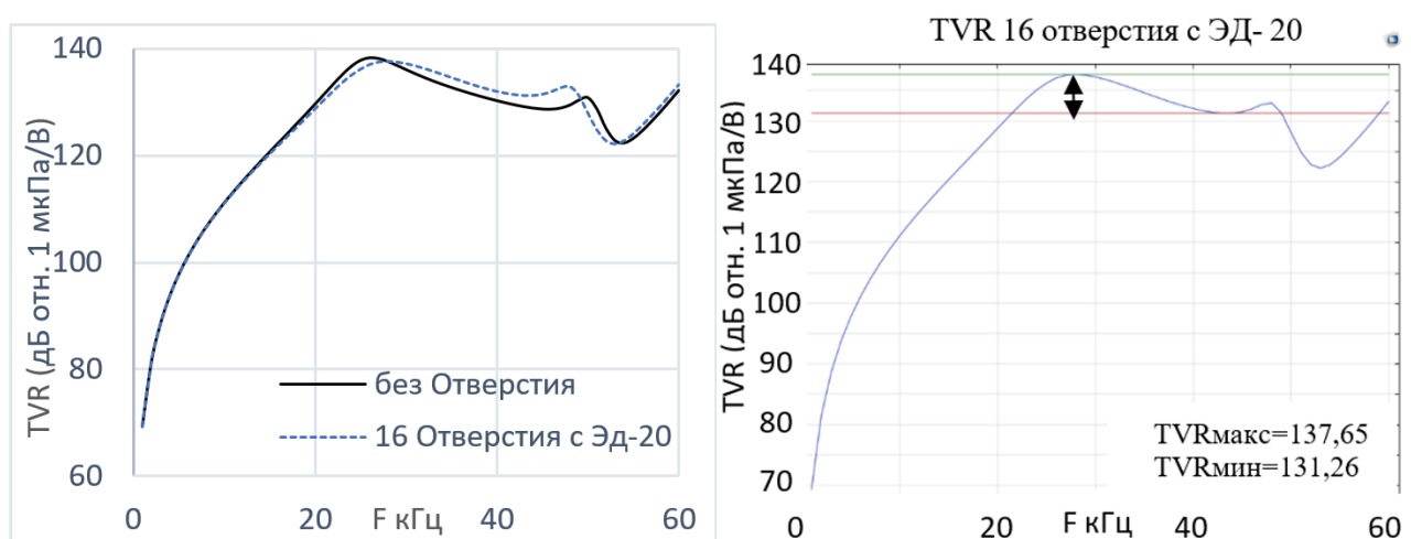
Рисунок 7 – Реакция на передаваемое напряжение (TVR) для пьезоэлектрического преобразователя с шестнадцатью отверстиями с заполнением ЭД-20
